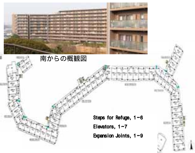
図2 東京首都圏に建設されたある10階建マンションの平面図．10棟の建物がEXP.Jで連結され全体で1棟と見なされているが，中にはエレベーターも非常階段も存在しない棟もある．
