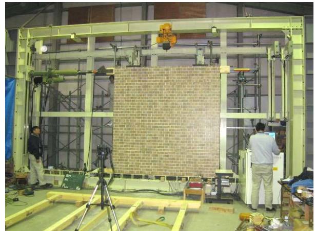
写真1 内外装壁の静的強制変形実験概観
