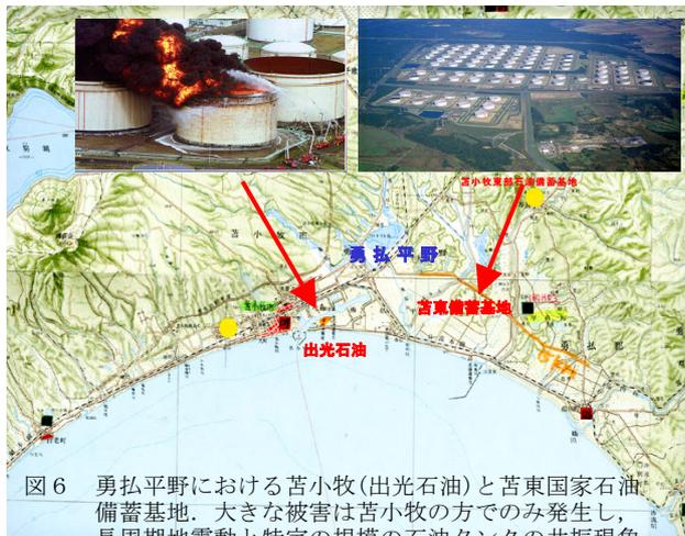
図6 勇払平野における苫小牧(出光石油)と苫小牧国家石油備蓄基地。大きな被害は苫小牧の方のみ発生し、長周期地震動と特定の規模の石油タンクの共振現象として理解される。
