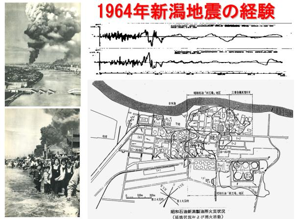
図2 1964年新潟地震における石油タンクの溢流被害と火災
