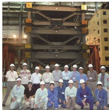
汎用慣性質量装置を用いた制御型ロッキングフレームの振動台実験 (日米共同研究)
