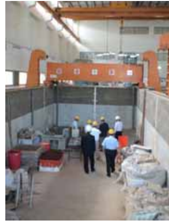
写真 - 6 ペーパードレーンの実験を行っていた大型土槽
