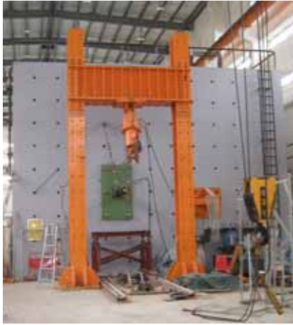
写真 - 5 大型載荷フレームと反力壁
