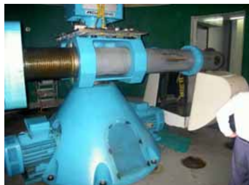
写真 - 4 遠心模型実験装置
