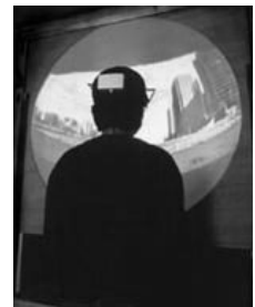
写真5 アイマークレコーダによる注意の誘導と景観評価実験
