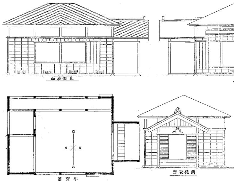
図6 北海道根室に建設セル改良日本風木造家屋建築仕様及図面<sup>5)</sup>
