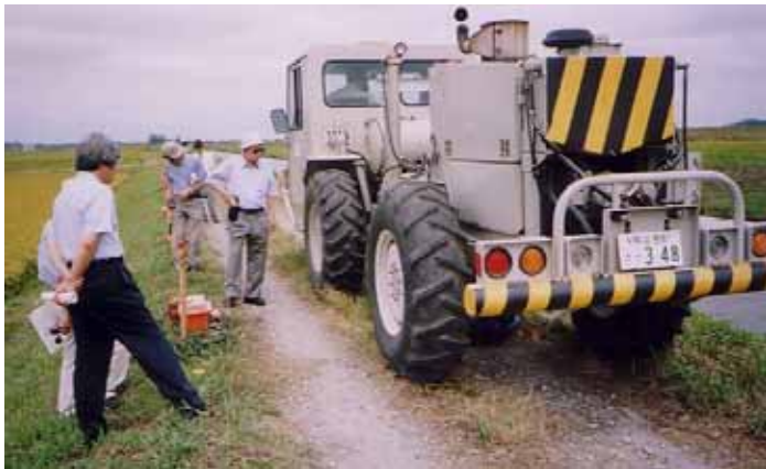
Fig.7 平成 13 年度、成田地区、地震波伝ば特性評価法調査における S 波ミニバイブ実験。中央は小林先生。右上はミニバイブの S 波プレート。
